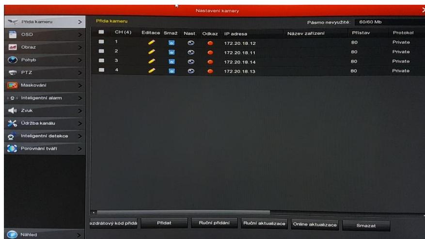
**Bezdrátový kód přidání:** Kliknutím na tlačítko pro přidání pomocí bezdrátového kódu se zobrazí odpočet 120s. Během odpočtu držte tlačítko na kameře, dokud nebude kamera spárována s NVR. Následně se objeví v seznamu kamer.
